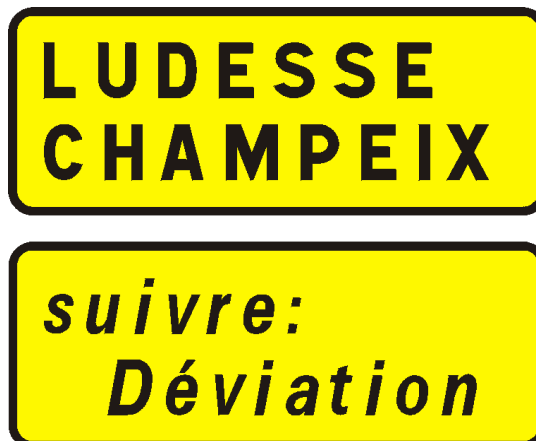
Panneau KD79b. Signalisation complémentaire d'un itinéraire de déviation avec la mention “ Dévi ation ”
